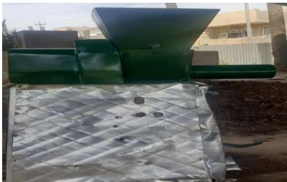
صورة رقم 1: الماكينة المصنعة محلياً لغرض تعبئة اوساط الفطريات الغذائية الاستوائية
