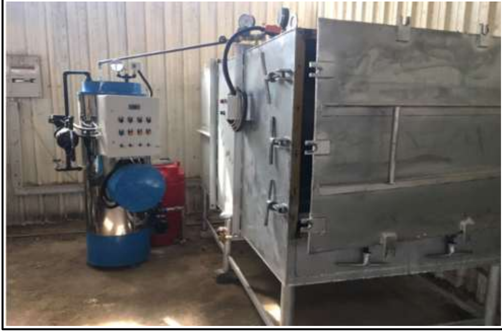
صورة 1: جهاز التعقيم المصمم والمصنع محلياً لغرض تعقيم اوساط تنمية وانتاج الفطريات الغذائية الاستوائية.
